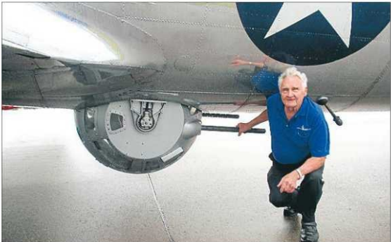
Det lille bugtårn, ball turet, hvorfra Lester Schrenk skulle skyde fra B17'eren, kan drejes 360 grader. Foto: Joseph Palmersheim/Sun Current
