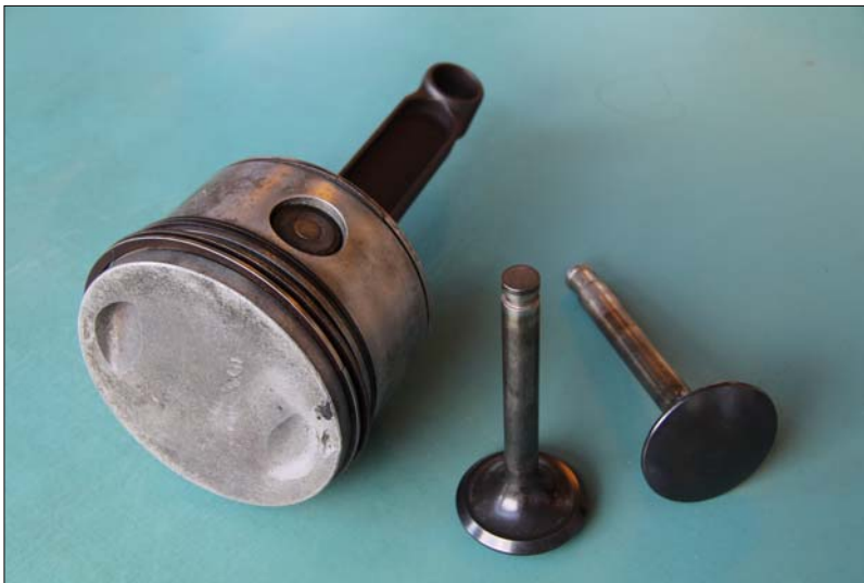
Stempel og ventiler fra en af flyets motorer
