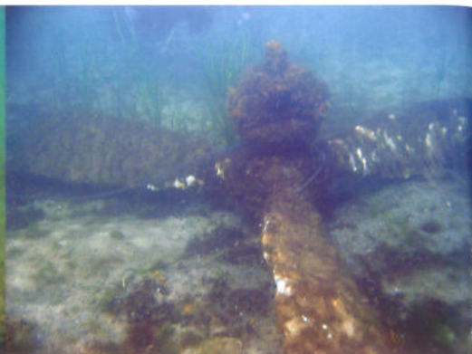
Enlig propel liggende på sandbund. Propellerne er blevet meget bøjet ved nedstyrningen. De øvrige vragdele er ligeledes meget fragmenteret og spredt over et større areal.
