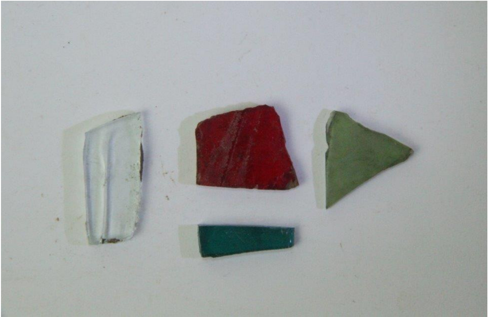
Vragdelsfelt 1: Plexiglas. Det røde kunne være fra en lampe i cockpittet. Begge farver plexiglas kunne stamme fra vingelysene.
