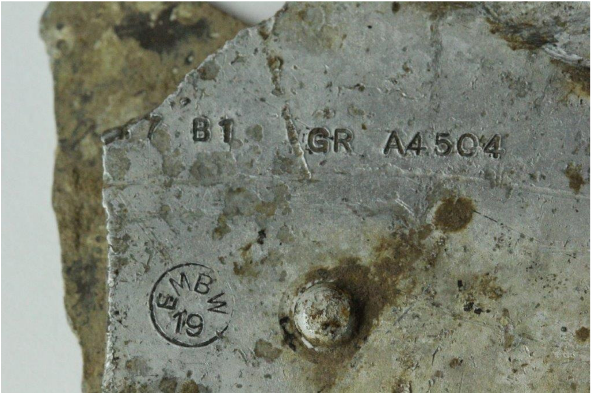
Aluminiumsstykke med fabriktionsnumre/inspektionsstempler.
