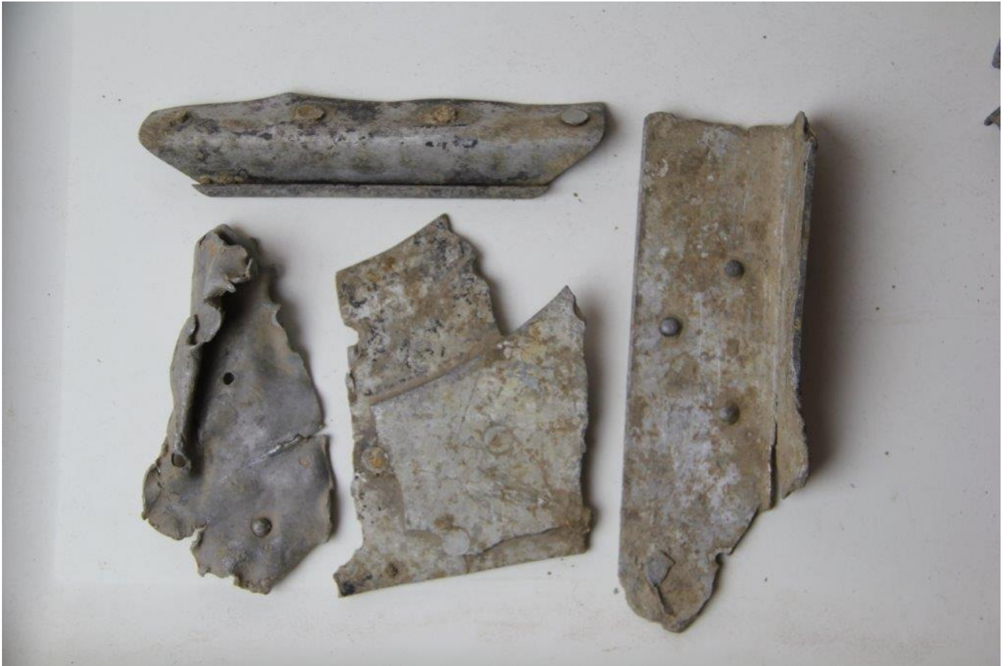
Vragdelsfelt 1: Nærbillede af nittede aluminiumsplader.
