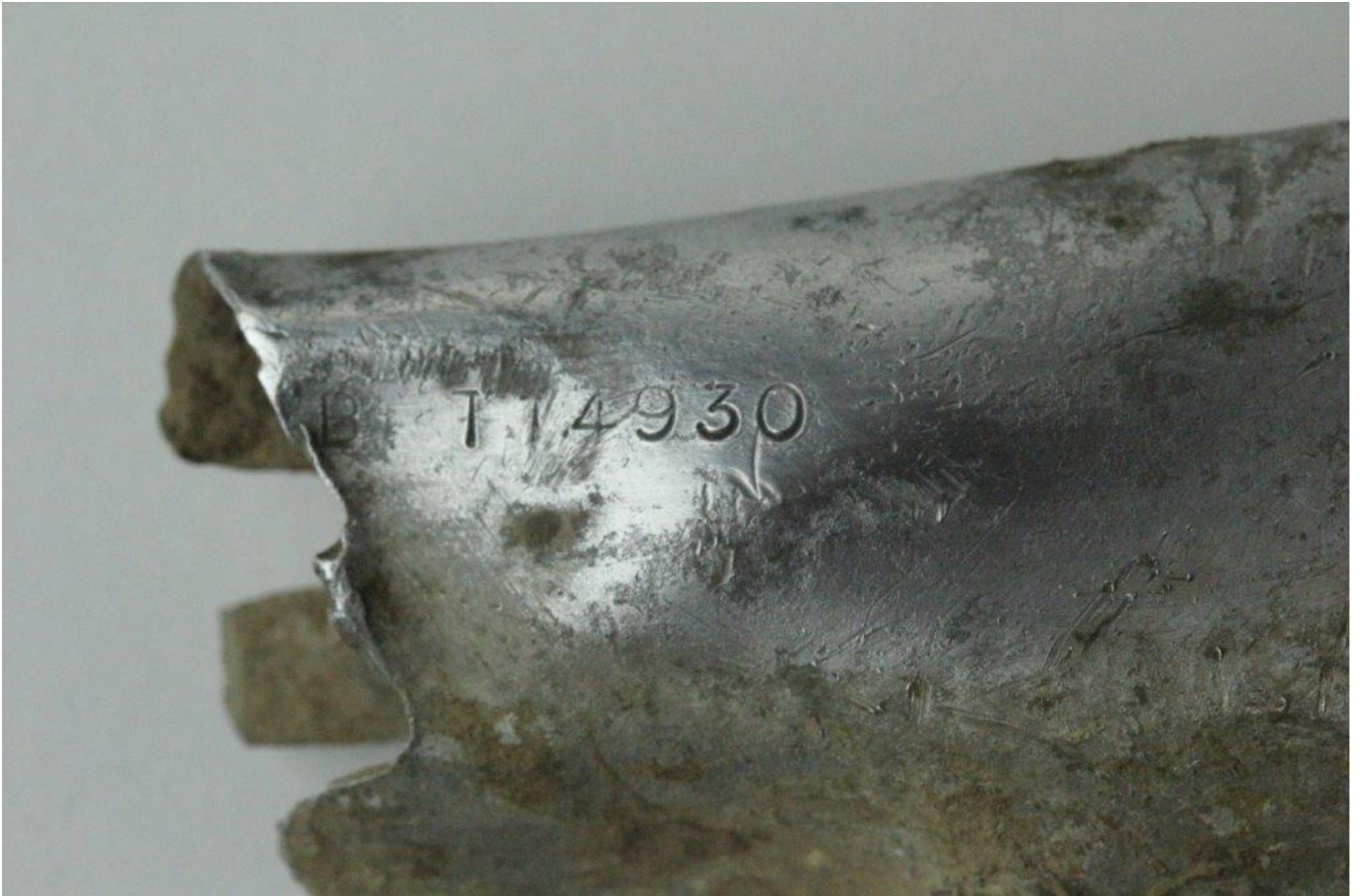
Aluminiumsstykke med fabriktionsnumre/inspektionsstempler.
