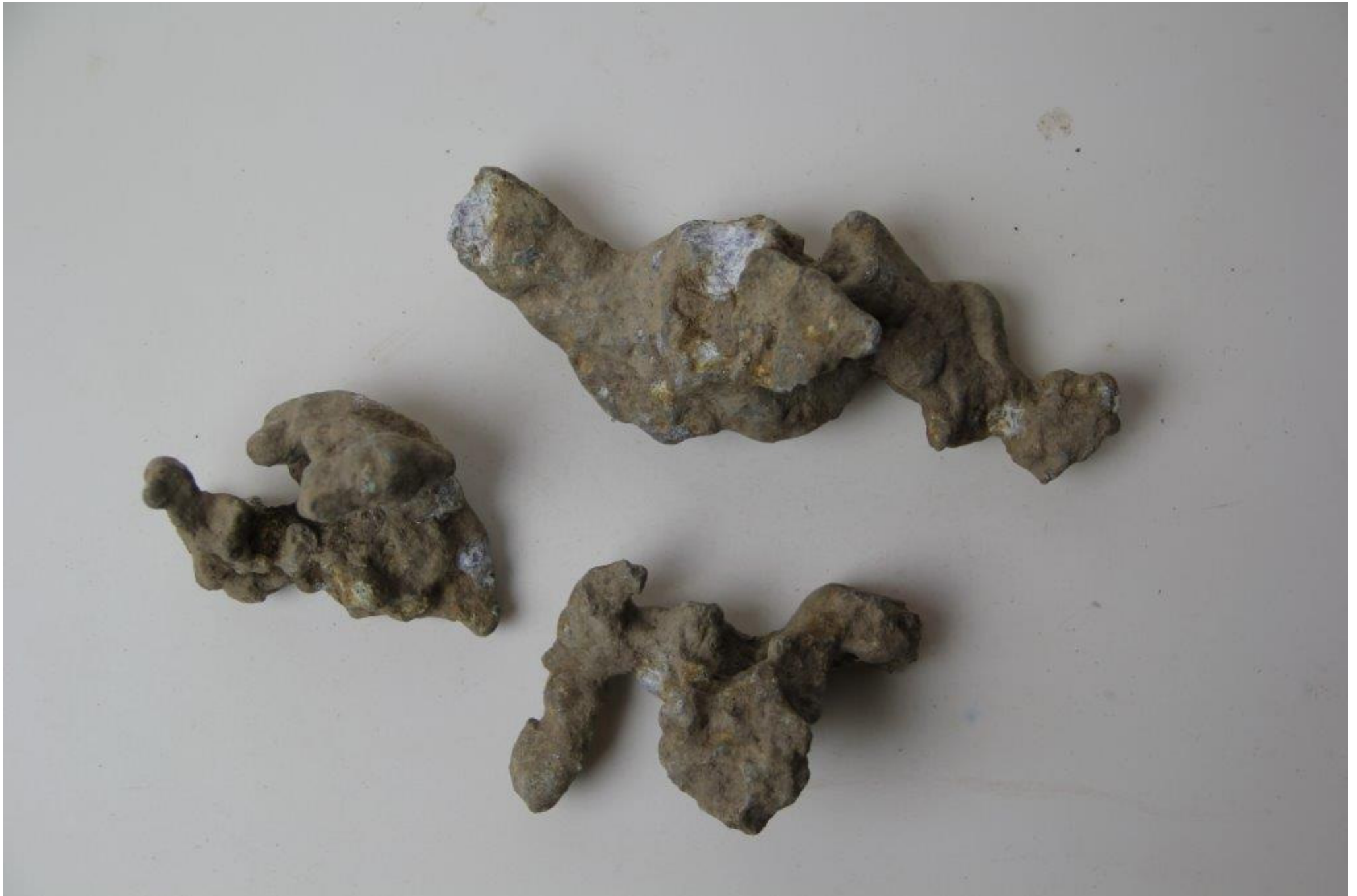
Vragdelsfelt 1: Nærbillede af smeltede aluminiumsklumper.
