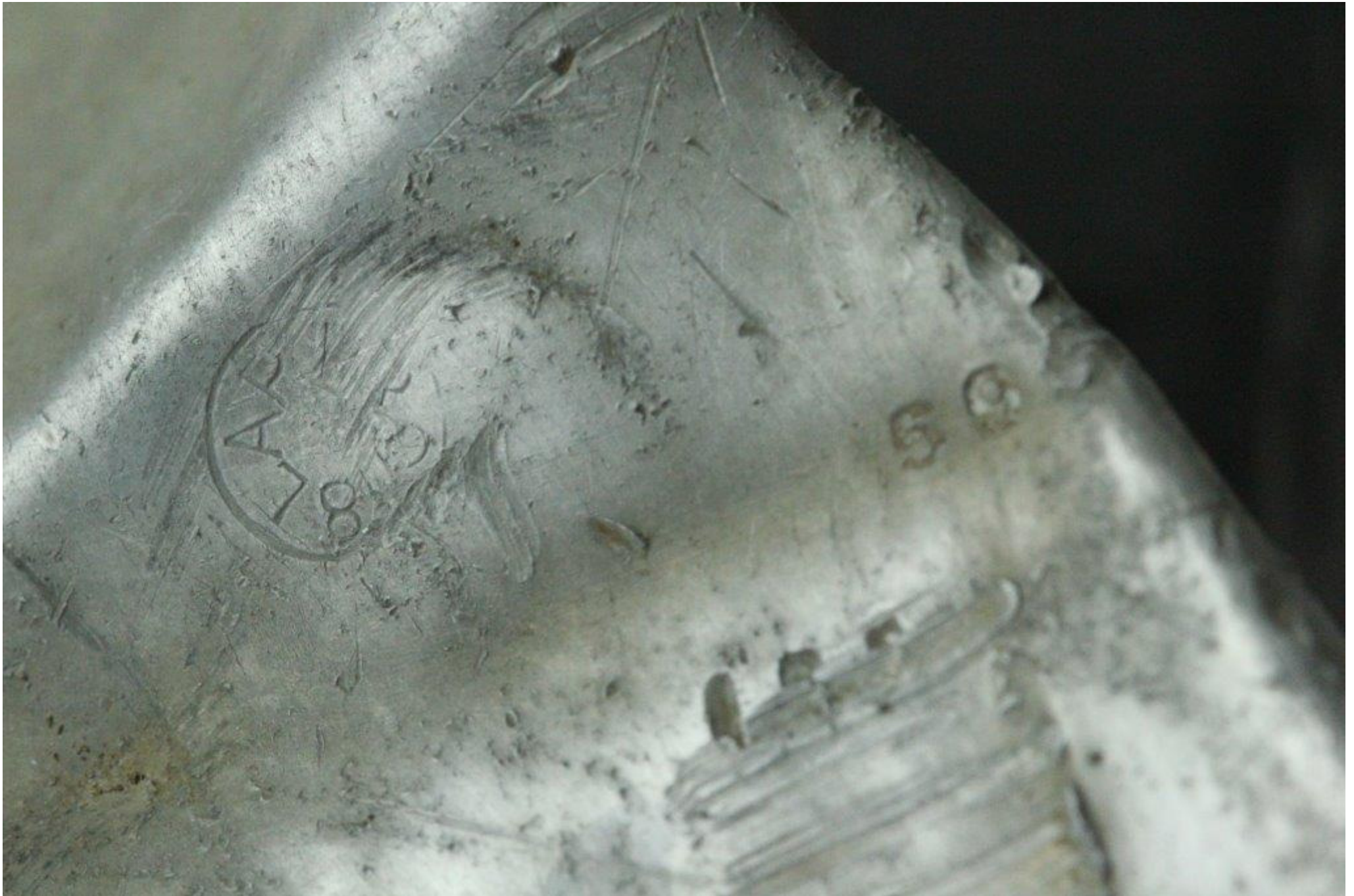
Aluminiumsstykke med fabriktionsnumre/inspektionsstempler.
