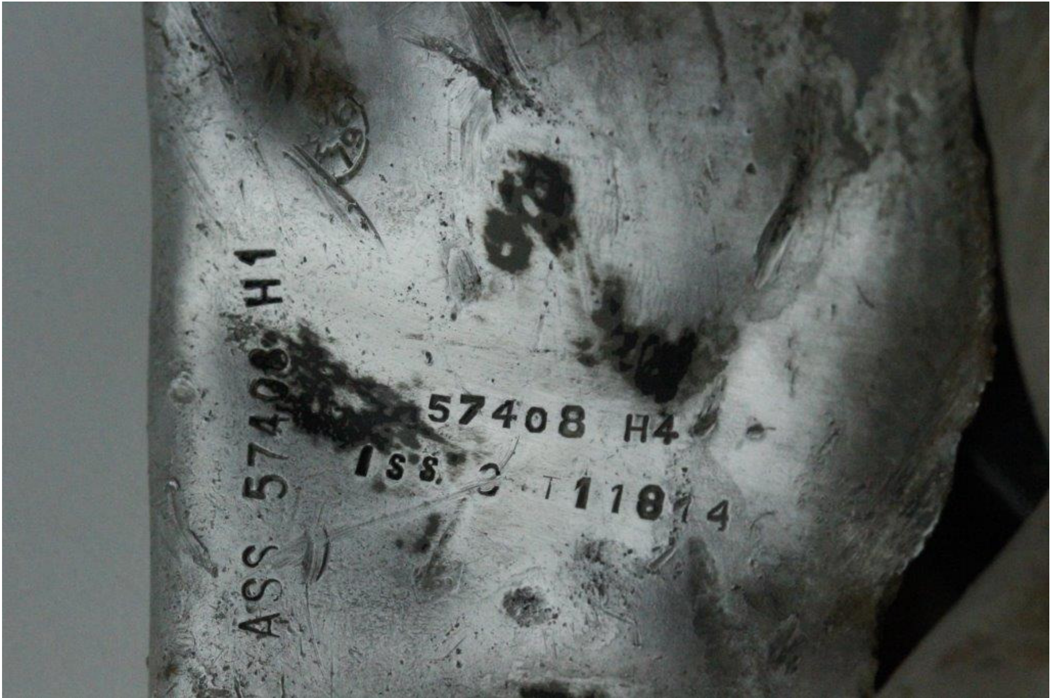
Aluminiumsstykke med fabriktionsnumre/inspektionsstempler.
