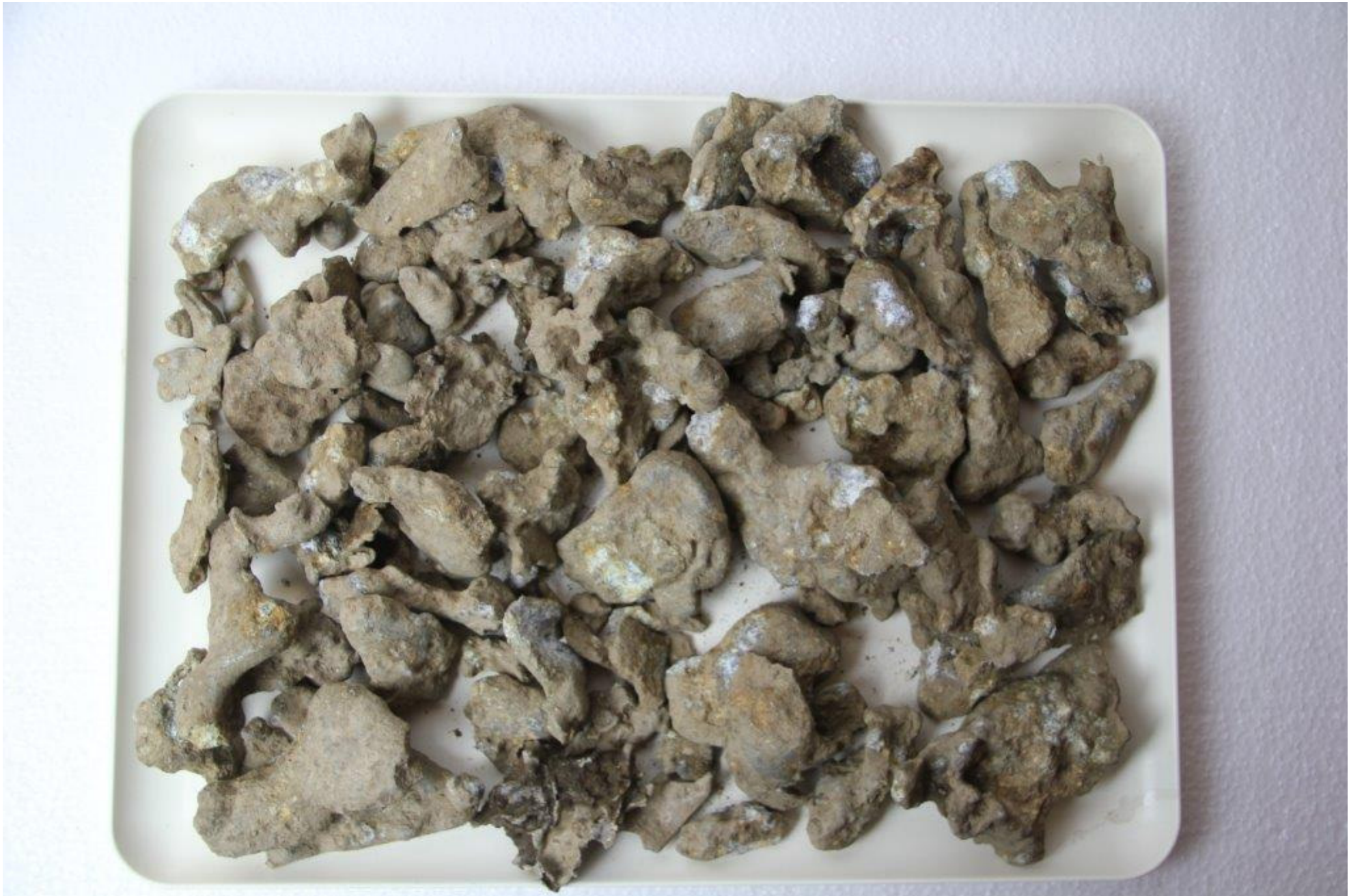
Vragdelsfelt 1: Smeltet aluminium fra det brændende vrag af BB378 (100 stk., 3 kg).
