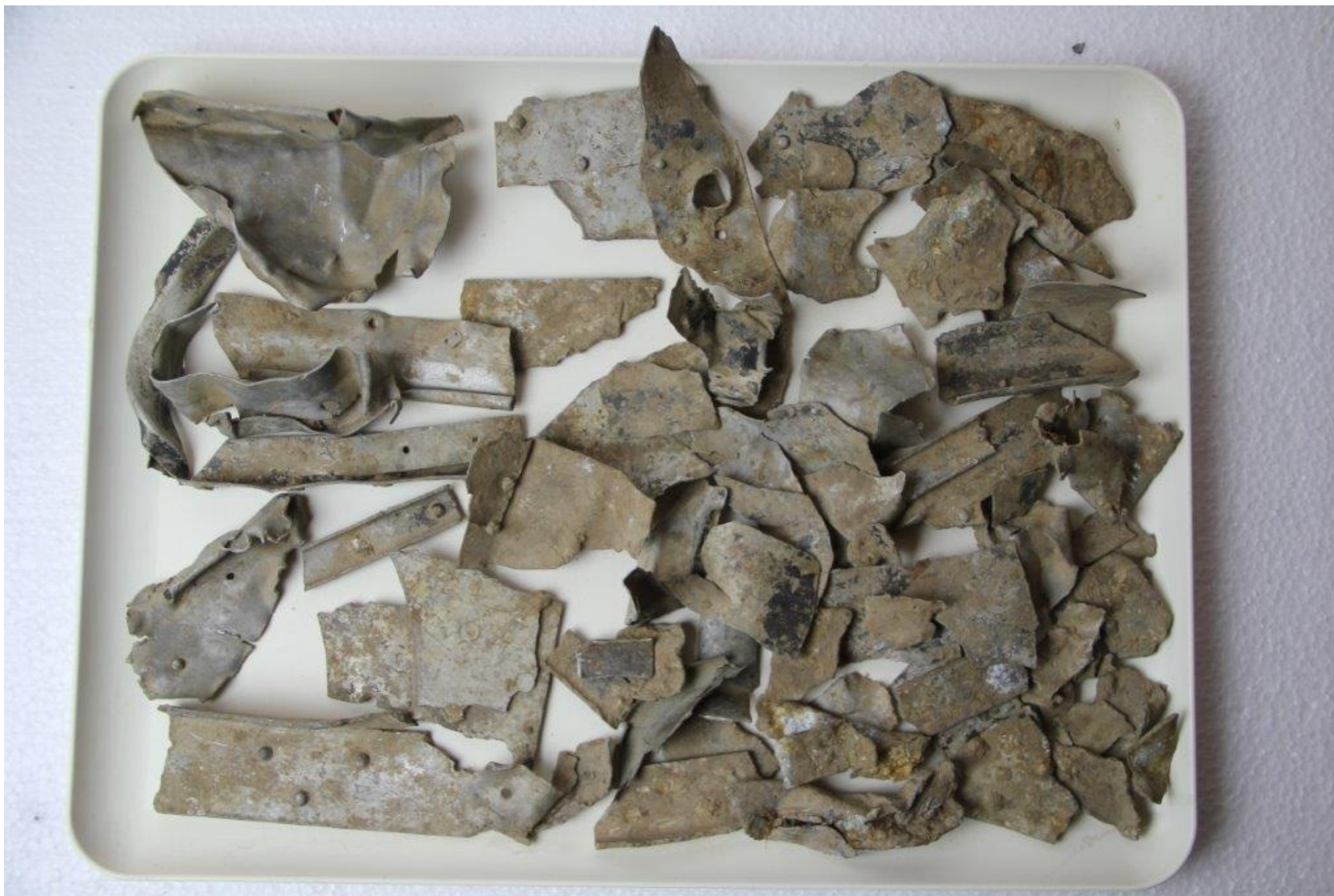
Vragdelsfelt 1: Pladealuminium, nogle med nitter (74 stk., 540 g).
