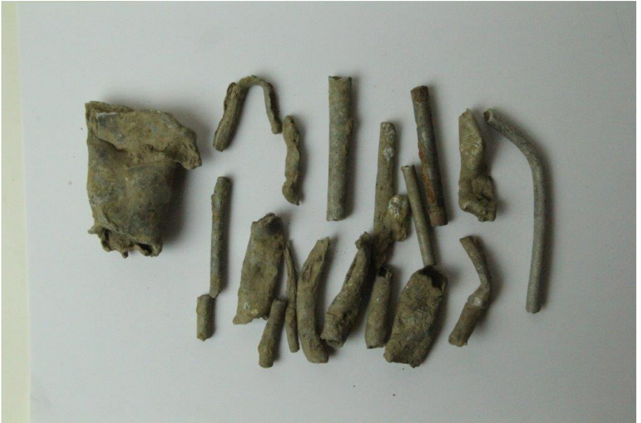
Vragdelsfelt 1: Aluminiumsrør (19 stk., 150 g).
